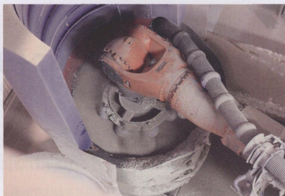
图3 Kuka 机器人很好地完成了复杂的挂浆回转运动
