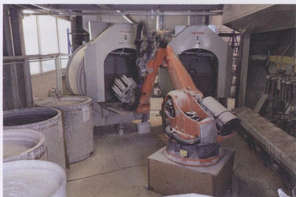
图2 在脱蜡炉 170℃ 的温度下石蜡熔化流出，型壳焙烧成型
