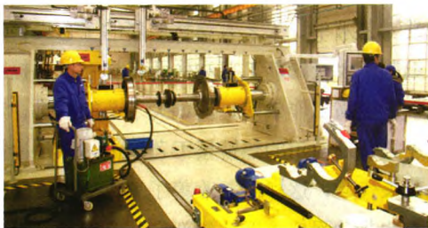
图3 机加工分厂压装轮对线
