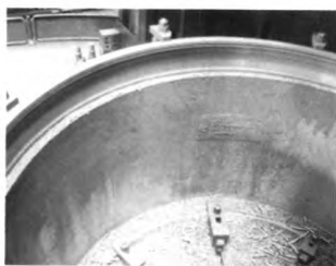
图5 底部压板提供轴向压紧力、顶部压板辅助压紧
