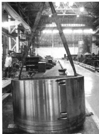
图11 使用高强度尼龙绳起吊工件
