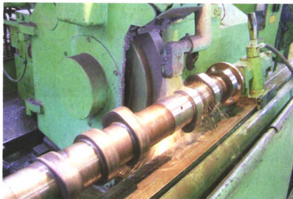
图14 凸轮轴磨床在加工产品
