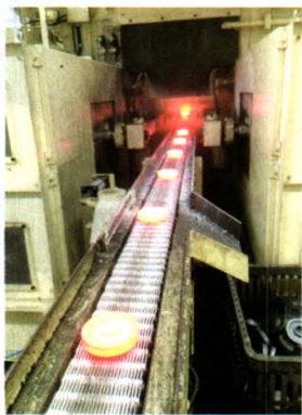
齿轮毛坯中频感应加热
