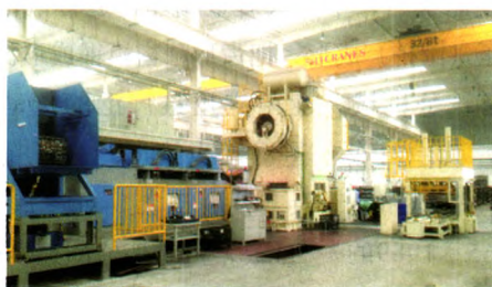
多工位齿轮热模锻生产线
