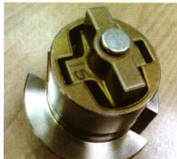
图7 粉末冶金联轴节与转子
