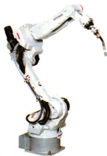
图2 首钢莫托曼弧焊机器人
