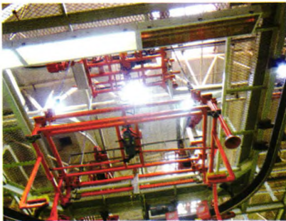
图4 解放J6焊装车间的带升降吊具
