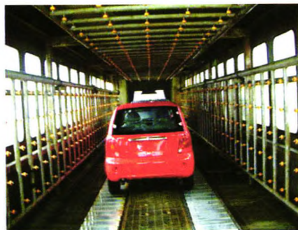
汽车淋雨线试验室
