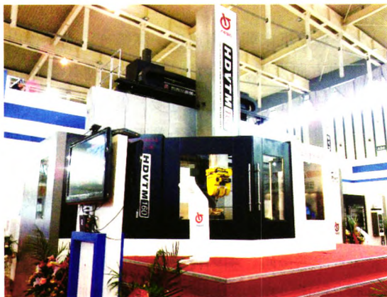
图11 HDVTM160X10/8L-MC高档立式铣车复合加工中心
