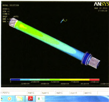
图3 取力器内轴的位移模型
