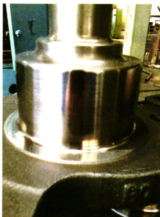
图1 抛光直纹缺陷
