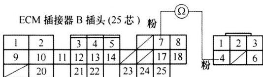
图4 检查EGR阀控制线路是否断路
