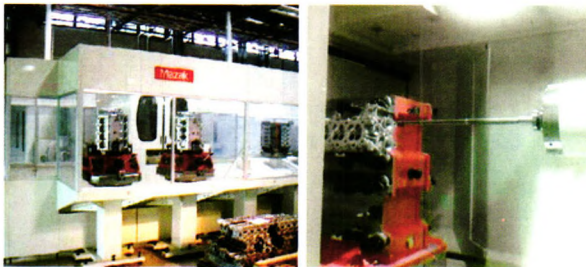
图1 FMS对汽车零部件的柔性加工
