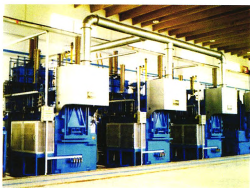
图3 BBH前室预抽真空多用炉及自动生产线
