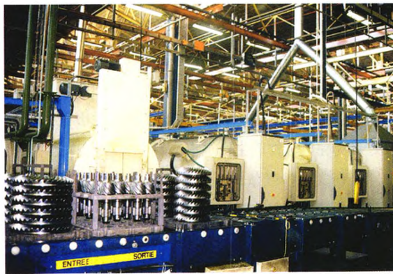
图1 连续式低压真空渗碳自动生产线
