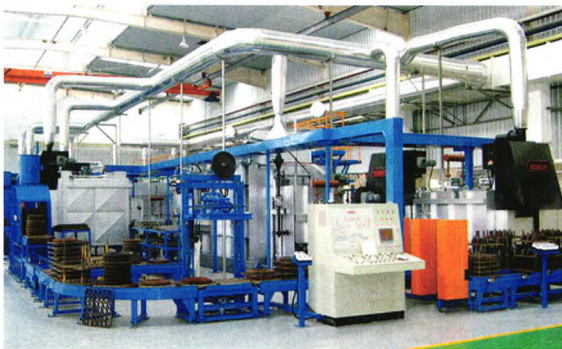
图2 连续式气体渗碳自动生产线
