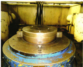
图2 改进后的内孔定位夹具
