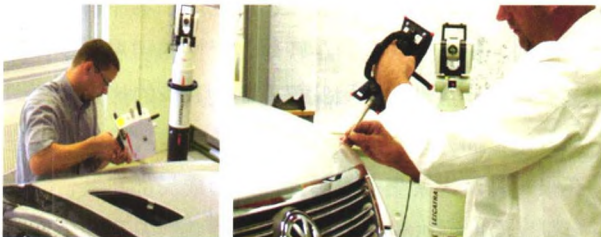
(a) 戴姆勒工厂前盖、翼子板间隙评估
