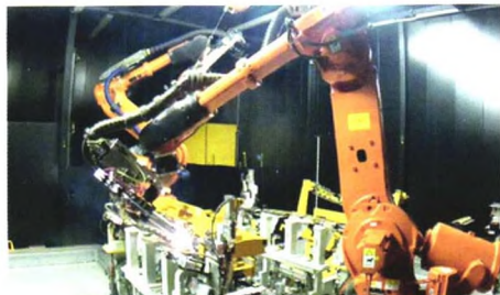
图7 前仓机器人激光焊接
