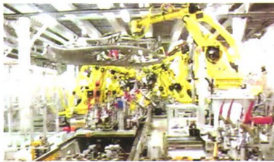
图5 机器人在侧围线上的应用
