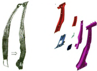
图3 侧面碰撞时B柱变形模式及结构
