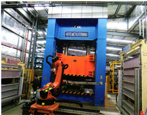
图1 超高强度汽车结构件热冲压技术和装备生产线
