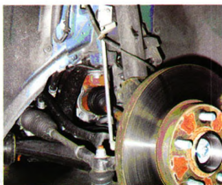
图1 盘式制动器在汽车底盘中的结构形式
