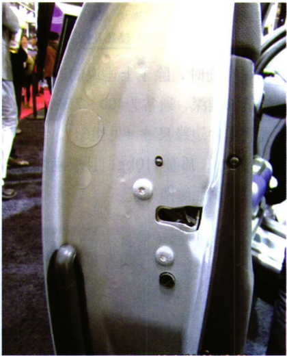
图2 整车外漏焊点扭曲
