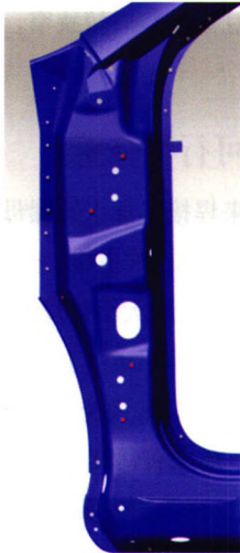
图5 螺栓紧固出焊点
