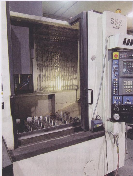
图 2 公司最新的高速立式加工中心——牧野 S55
