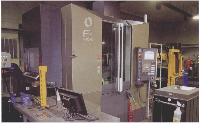
图 3 这是公司的另一台新的高速立式加工中心，牧野 F5。在 F5 具有粉尘排出系统，用于加工石墨电极和磨光钢模块
