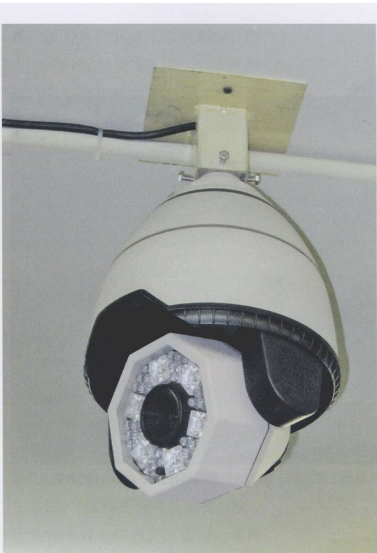
图 5 Quality Tooling 安装了红外 LED 摄像头，可以平移和缩放来查看机器的控制画面或作业区域
