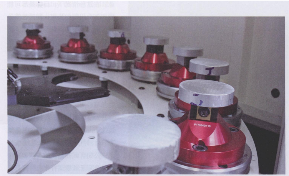
图 1 5th Axis 约有 90% 的工件采用其内部设计的燕尾槽工装夹具。由于该夹具能够在工件 0.006 in 的余量上夹紧固定，因而降低了材料成本，并节约了加工时间
