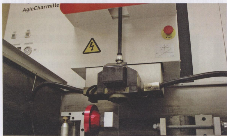
图2 燕尾槽夹具的定位销重复精度达0.001in。这使得该车间的零件能够在不同的机床之间无缝移动，其中包括GF AgieCharmilles Cut 20型EDM线切割机床
