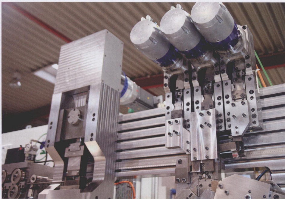
图1 TPM plus power 系列伺服驱动装置不仅在功率数据和安装空间上具有优势，其铝合金外壳也开创了机械设计的新天地
