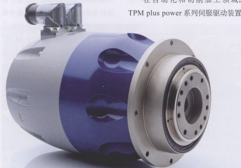
图 2 此伺服驱动装置把有着很高功率密度的永磁同步电动机与有着很小齿侧间隙和高抗扭刚性的精密斜齿行星齿轮变速器集成在一起
