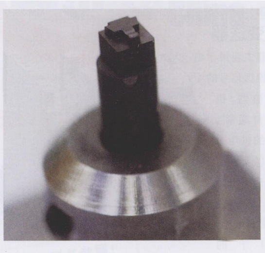
图2 利用 Zecha 公司研发生产的刀具能够加工出高质量的电火花加工石墨电极
