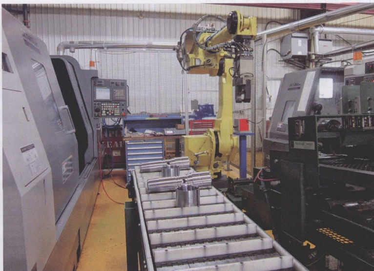
图 3 加工完成的油管排空器筒体和衬套抵达工厂的第一个机器人单元的出料输送机。 在实施该单元格的过程中, Plainsman 公司得到了许多宝贵经验, 如在平衡周期循环时 间和规范流程方面, 不仅能应用到后续的单元格项目中, 而且能应用到该厂尚待实施 自动化的领域
