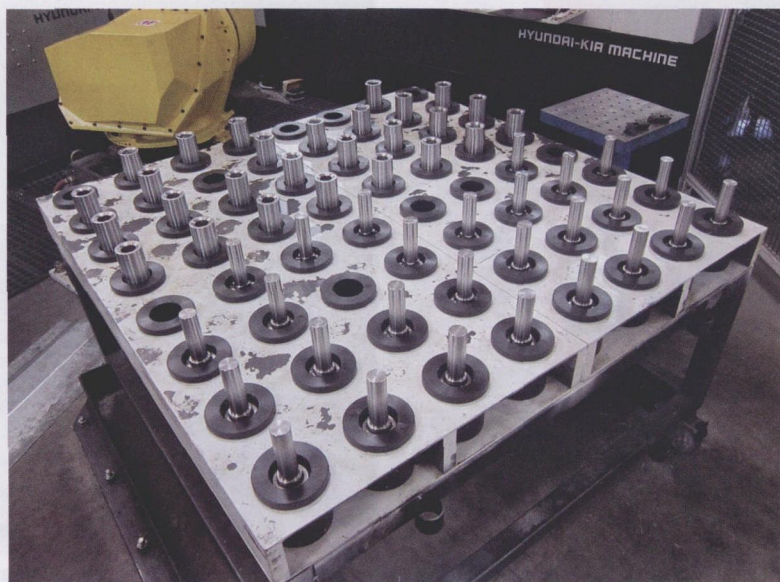
图2 第二个单元的灵活性可部分归功于托盘,此托盘有厚重的基座,为机器人提供一个恒定的参考点。由于软件算法能为机器人 2D 视觉系统把托盘分成若干部分,公司便能在同一种托盘上为不同的工件装载不同尺寸的坯件
