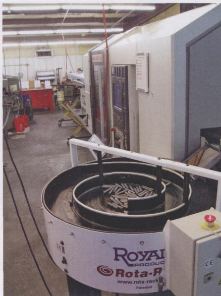
图 2 实施成功无人值守加工至关重要的因素：一是上下料，棒材喂料机在机器的一端通过一个圆盘传送带耦合到另一端，用于搬走和收集已完成的工件；二是完成工件，在上面的车削中心中，转台上的去毛刺轮不需要再额外进行去毛刺工作
