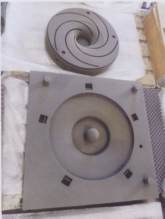
图 3 采用砂型制造金属铸造模具
