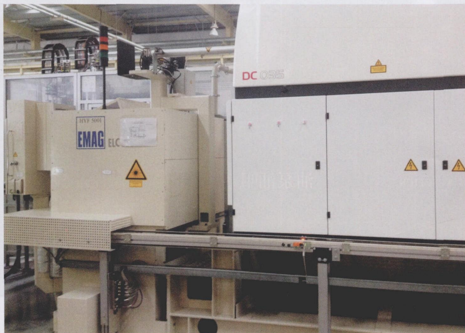
图 1 埃马克 ELC 160 机床实现了一机多用，减少了三台设备的资金投入和占地面积，为东风日产极大的节约了成本
