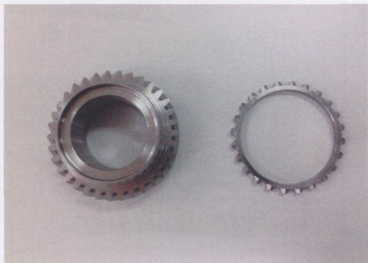
图2 激光焊接的齿轮和结合齿
