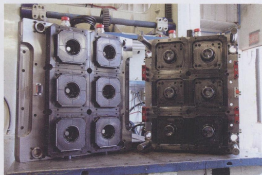
图 4 Moulexpert 公司认为，3+2 加工将有助于该公司生产这种六型腔模具
