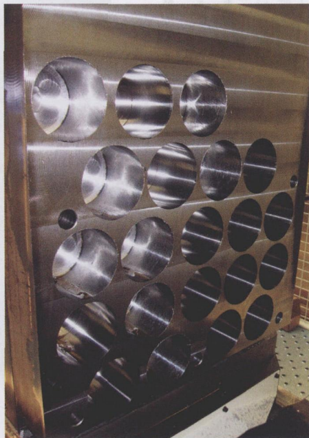
图 3 刚性好的机床同时具有重切削力和高精度的特性，图中所示的直径 4 in 的孔就能够说明这一点，有的使用直径 4 in 的扁钻一次走刀便可完成，有的则是通过螺旋铣削以 210 ipm 的速度加工完成
