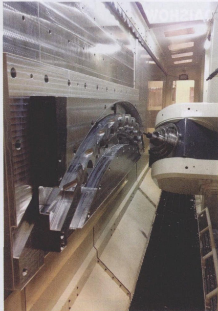
图 4 围绕旋转轴的大范围运动可以合并装夹步骤，在一个周期内进行极端或复杂角度的加工
