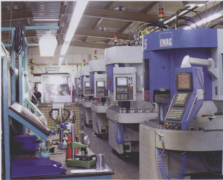
图 3 20 台 EMAG VL3 型组成的拣选生产线上的车床采用了 QLC 卡盘，该型号车床装有两个垂直设置的车削单元
