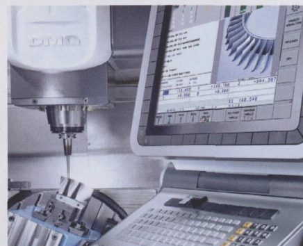
图4 对小型复杂零件，用DMU monoBLOCK®和DMU eVo系列5轴万能机床加工，其数控技术能适应任何工件大小要求
