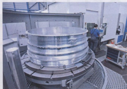
图3 如果需要对大型航空航天工件进行5轴完整加工，最大行程6000 mm的DMG MORI龙门机床提供充足空间
