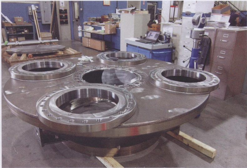
图 4 Faro Vantage 激光跟踪仪用于测量大型零件。该设备将光束发射固定在工件的反光靶上，光束反射离开目标，沿原路返回跟踪器。当它重新进入时，二角编码器测量仰角和旋转角，而绝对测距仪确定反光镜的三维位置
