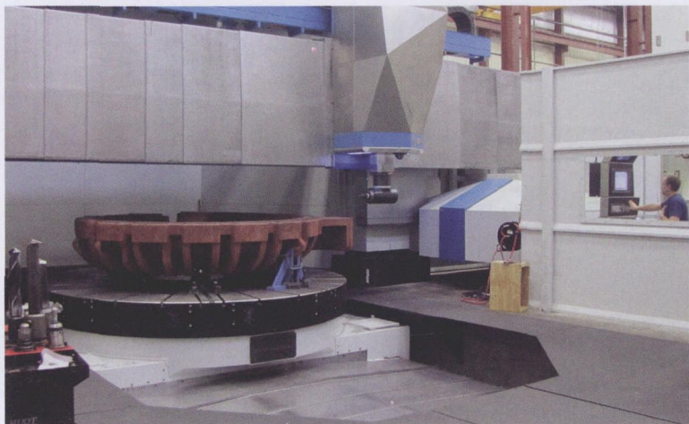
图2 博斯特 60 CY 4000 立式车削中心设有可更换的动力头,使其能够执行车削、顶部铣削和侧面铣削加工
