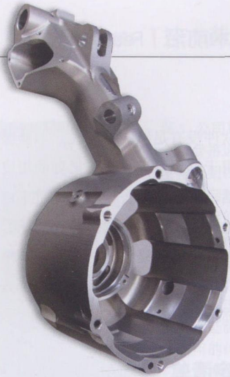
图2 Applied Engineering公司专业加工复杂航空部件。这些部件采用6061铝合金加工而成，加工批次量为20个，并要求公差为 \pm 0.0004 in
