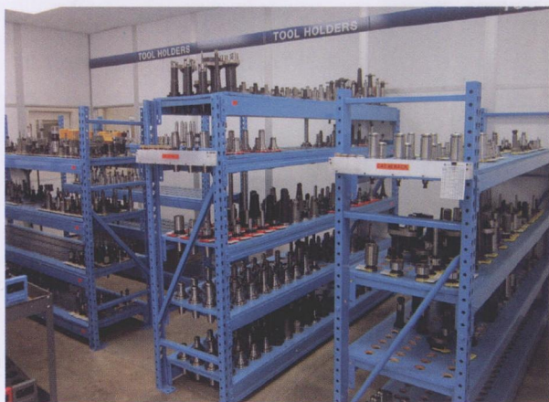
图5 公司每6个月会将近期没有用到过的刀具架向后移动至库存的前面以便进行重新使用。除了显著地节约成本之外,这种重新认证和循环使用的体系对于流程标准化做出不小的贡献
