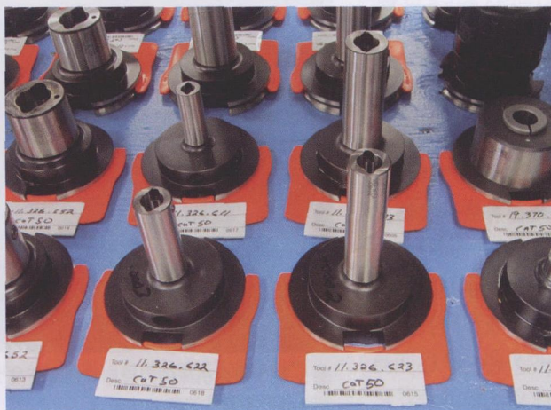
图 4 目前已经利用被动性 RFID 标签获取刀具架在整个加工工厂内的行踪
