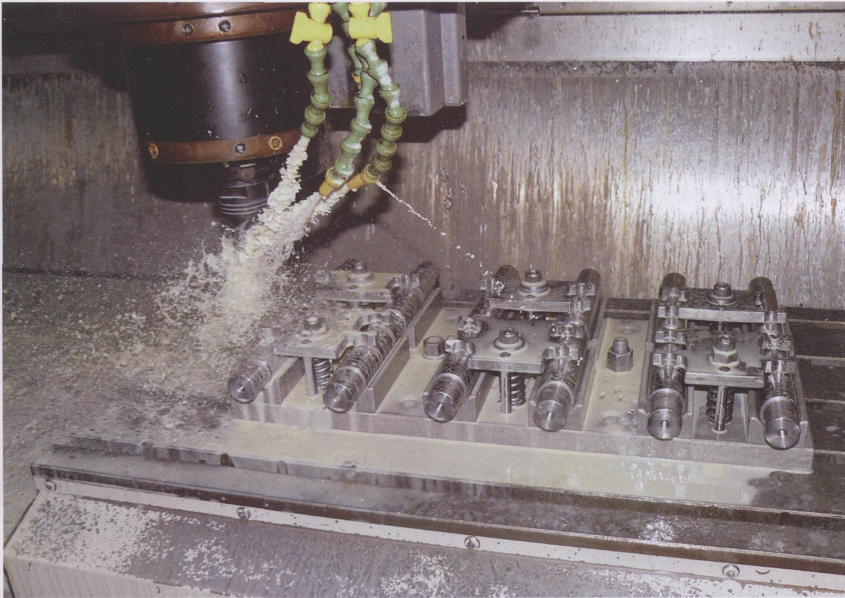
图 1 在加工出 2800 个螺栓工件后，TRS 3 刃螺旋钻头的刀刃仍与新的一样
