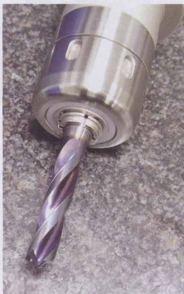
图 3 TRS 3 刃螺旋钻头主刀刃的几何形状与弯曲突起设置，使得螺栓横孔的切削时间短
