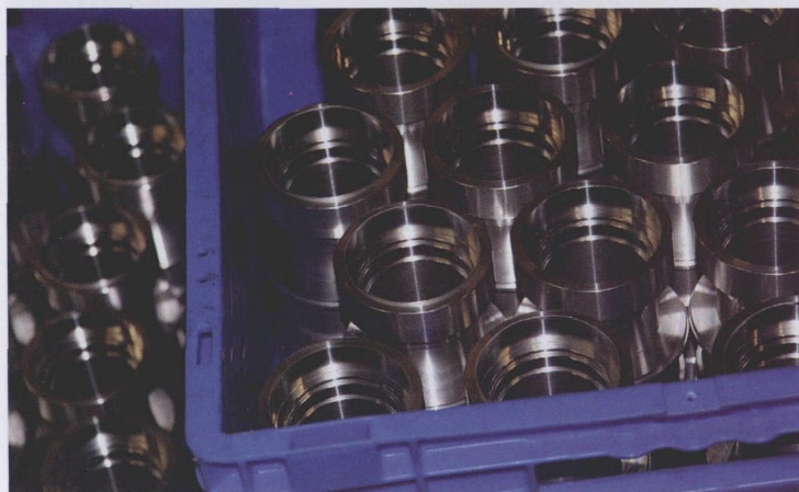
图3 Franz Schirling 公司车削加工的典型材质工件，加工工序的最后阶段进行切开挖取
