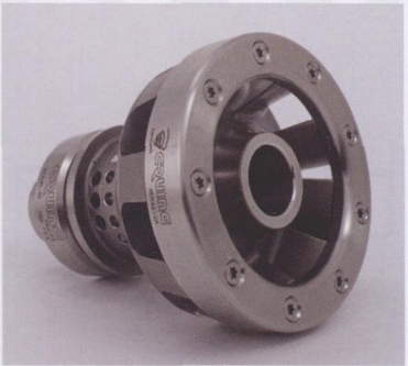
图 4 迄今为止 Reiser 公司在加工作业时使用的带透平的最大刀具底座外径为 105 mm
