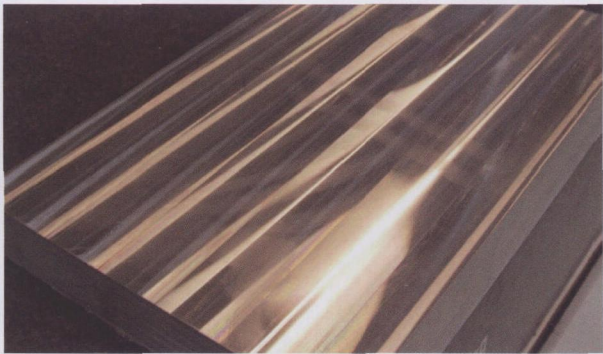
图 2 干式铣加工铝制件的表面质量可达 Ra=3.1
