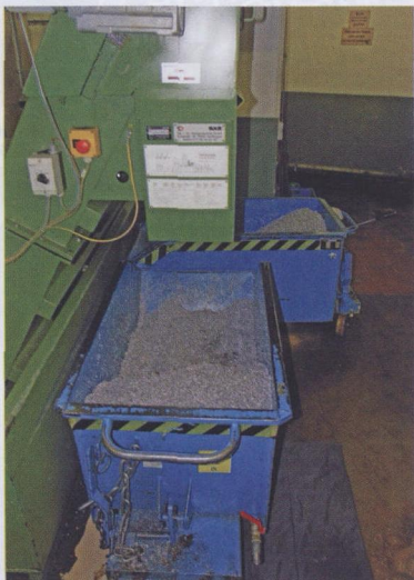
图2 第一级处理由一输送装置将干燥的刨屑清理出来
