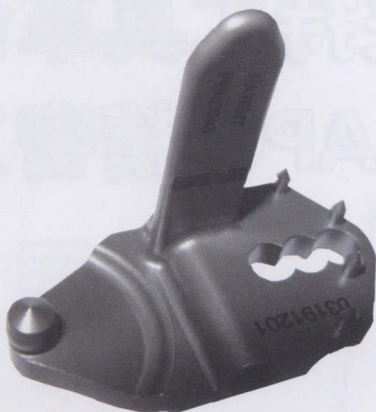
图2 选择3+2式机床的主要原因是为了确保这个钛金属部件类似于鳍片的过渡面的高质量加工
