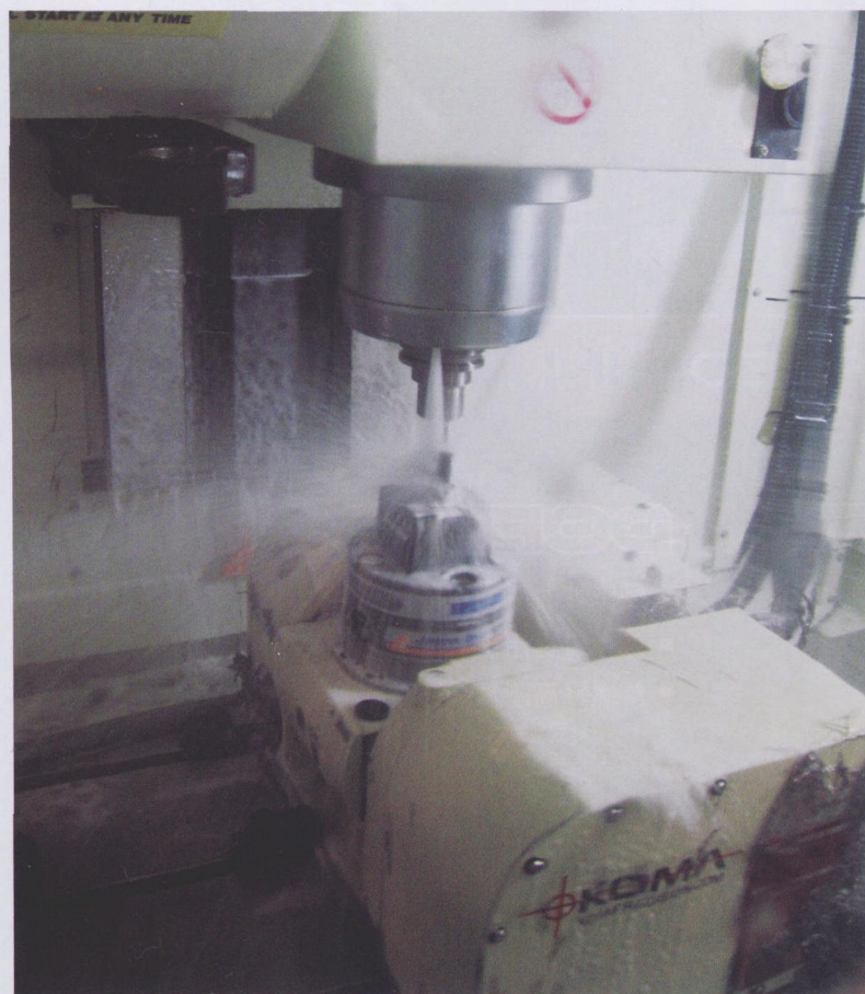
图1 这台加工中心采用了重载倾斜式枢轴来满足 3+2 式机加工
