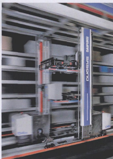
图 1 大福公司的 DUOSYS 系统能达到每小时 2200 箱的最大吞吐量
