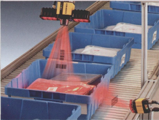
Dataman 500 型条码识读器采用 Hotbars 技术识读软件，条码识读率几乎达到 100%
