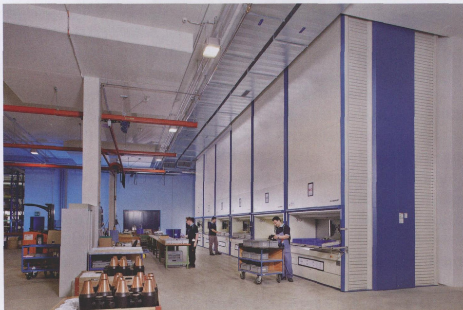
图 1 Brugg Cables 和 Hanel 及 Resoplan 公司一起用六部现代化的 Lean-Lift 对中心仓库进行了设计和优化
