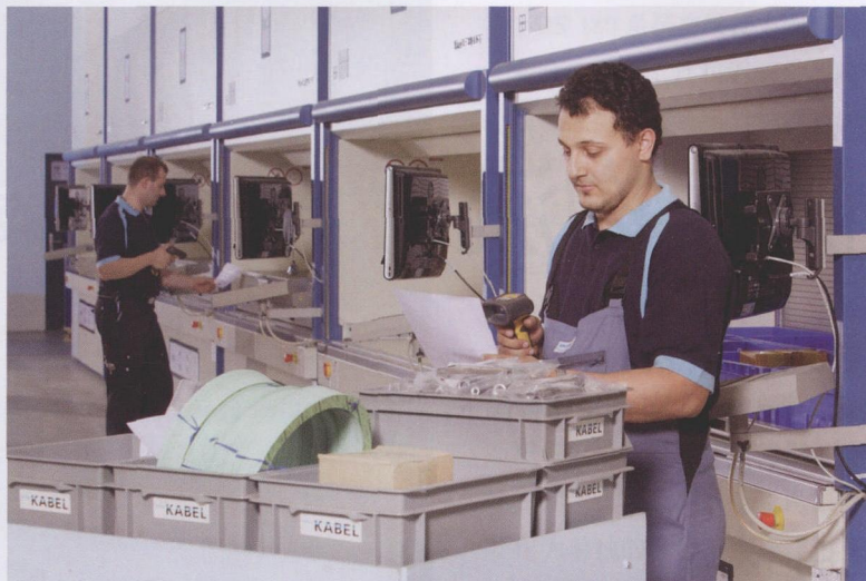
图 2 用条形码和电子触摸屏在 Lean-Lift 上直接采集所有过程，将全部仓库活动都高效、透明地以电子方式记录下来
