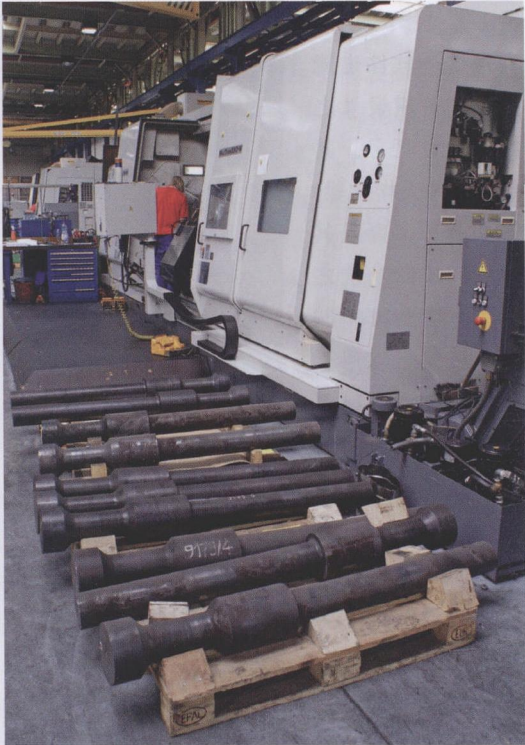
图 6 在带有副主轴 CNC 数控车床中完成活塞杆的全部加工
