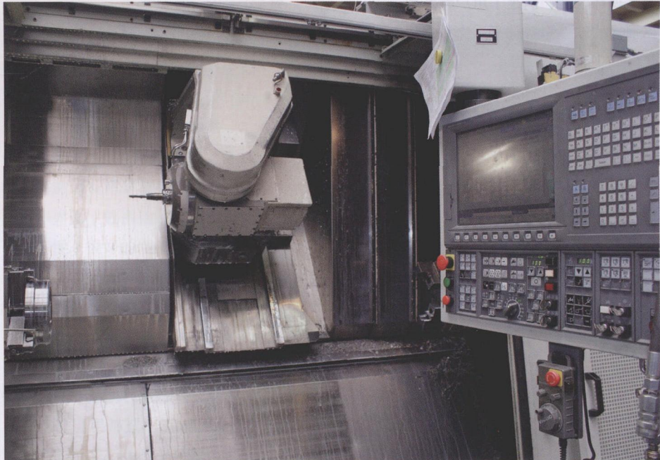
图 5 铣削、车削和钻削，所有这些都可以在这一带有副主轴 CNC 数控车床中完成
