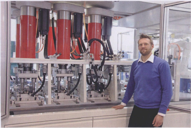
图 2 冲压 - 冲裁 - 弯曲设备配用了 8 根可以单独编程控制的行星滚柱丝杠
