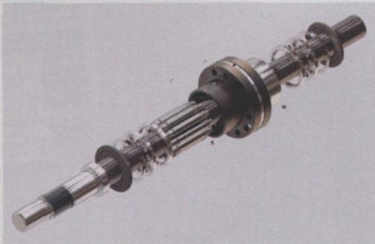
行星滚柱丝杠用旋转的螺纹丝杠代替了滚珠丝杠中的钢球
