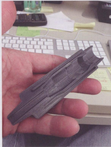
图 3 这是 Baklund R&D 公司用 3D 打印设备生产的一个功能部件
