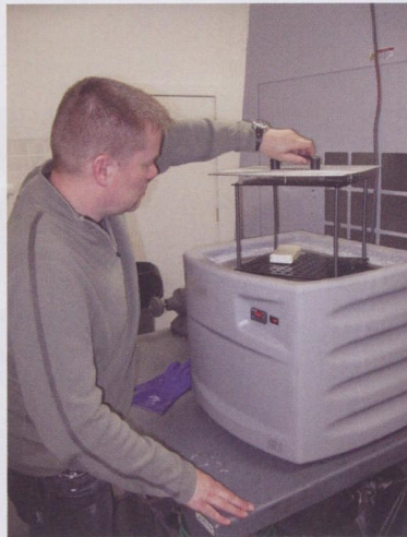
图 2 用 Fortus 400M 制造的最后一步是冲洗掉支撑材料，图中 Baklund 先生正在检查雪茄盒的生产进度
