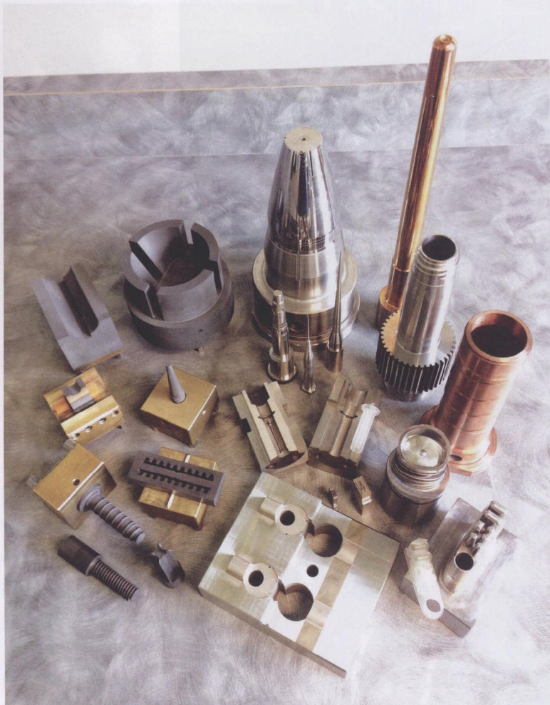
图 2 Erowa 的 50 mm 支架上不同大小的电极以及型芯和型腔模具部件和压铸零件
