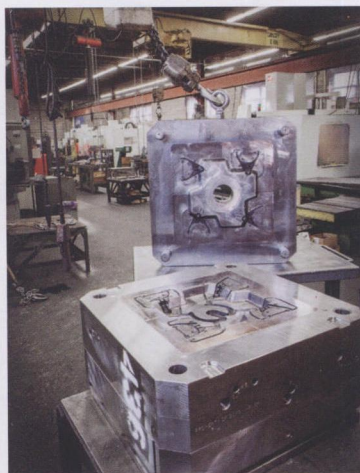
图1 试模后的换挡拨叉压铸模具
