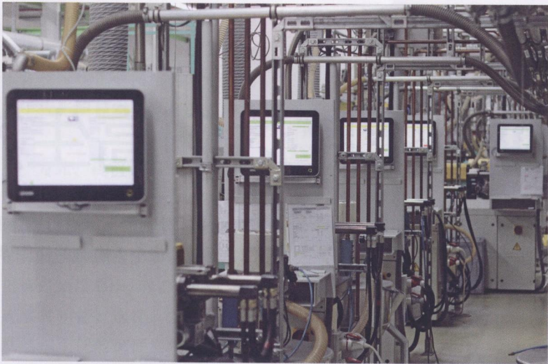
图 2 工业 PC (IPC) 符合 Vesa-100 标准, 可直接安装在机器上
