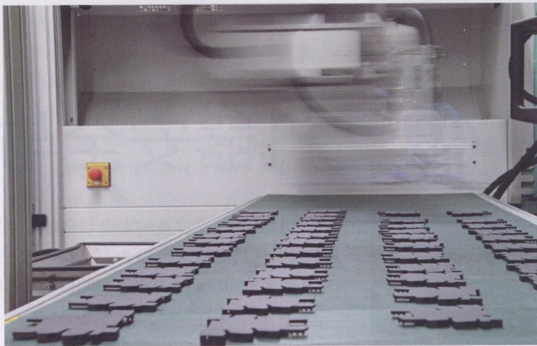
图 4 在该生产作业中正在生产大量各种大型人工合成材料外壳
